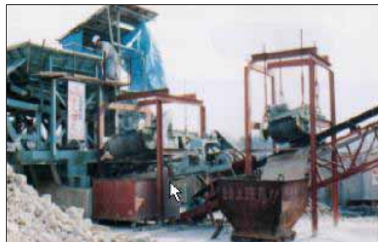
鉄筋等不純物除去、永磁式吊下磁選機
