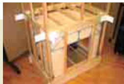
コロバ制振システム「方舟くん」の力学解析用模型
