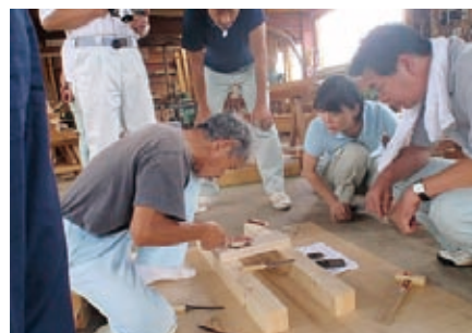
技能者が行う鉋台の調整作業を見つめる教員達（新潟県2校の合同）
