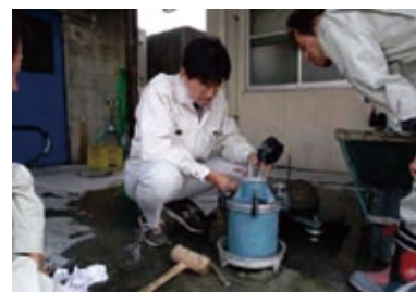
高強度コンクリートの空気量を測定する教員 (栃木県立宇都宮工業高等学校)
