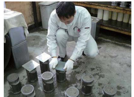
建設工学科教員のコンクリートの配合設計とコンクリート試験技術実習（今市工業高等学校）
