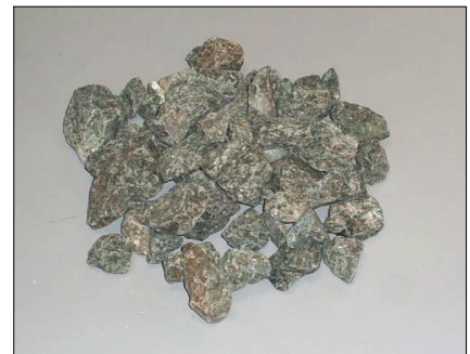
地盤改良で使用する砕石(20～40mm)
