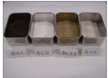
発生土と固化材
