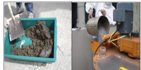
下水汚泥の脱水ケーキ（左）と混合装置への石炭灰の投入作業（右）
