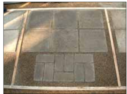
試作ブロックを屋外に設置して、保水性、温度低下率、劣化率等の実験を行っている
