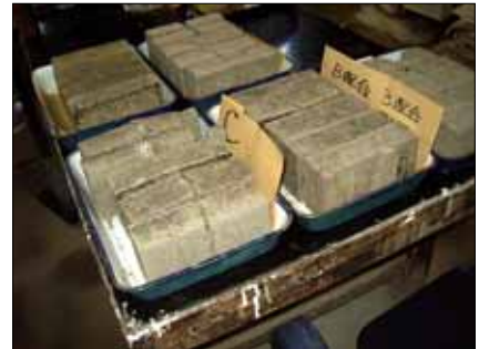
さまざまに配合を変えたブロックを試作している
